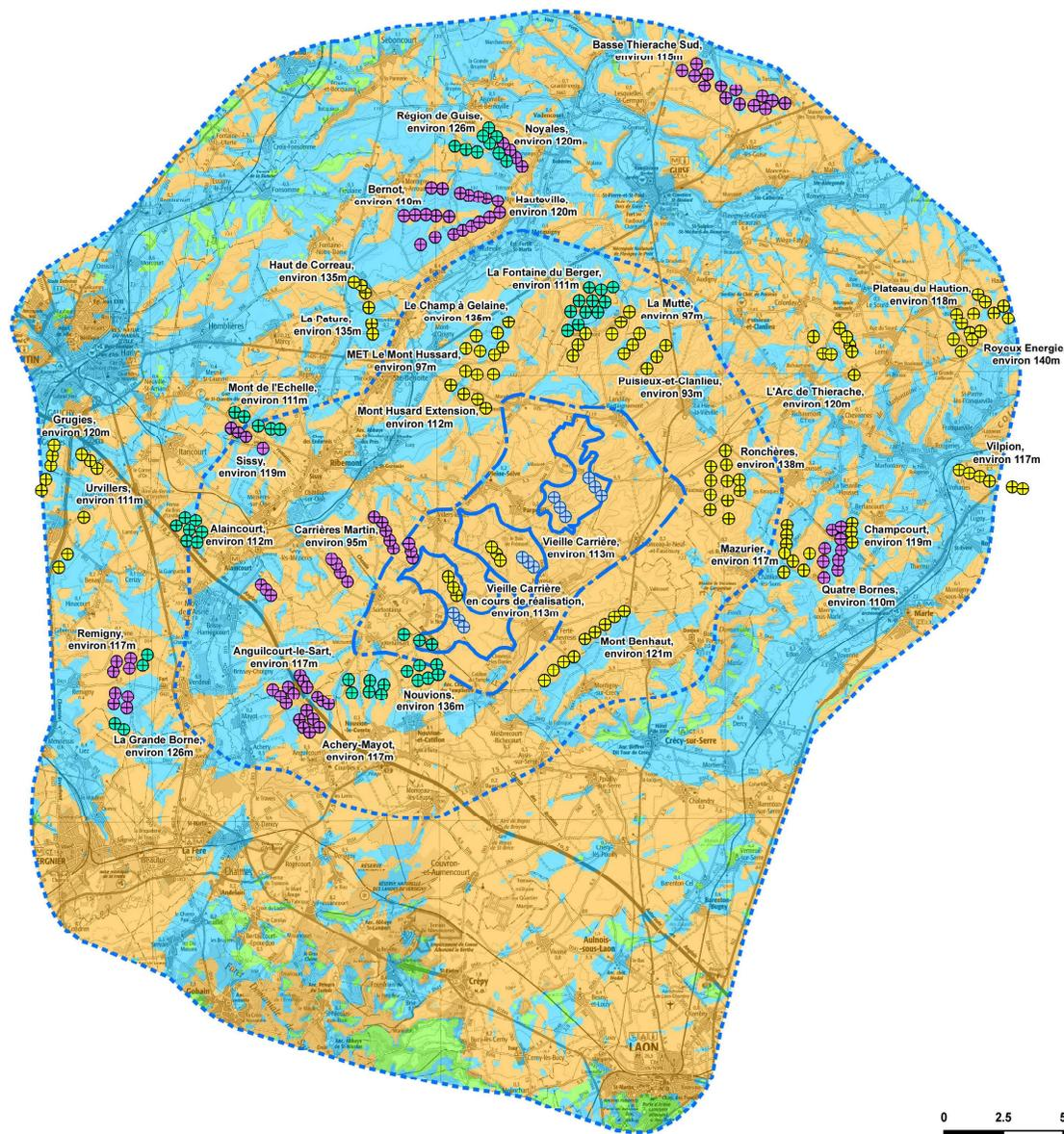
⊕ Eolienne du projet éolien de Vieille Carrière (hauteur de nacelle + un tiers de pale)
