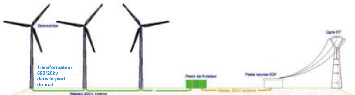
Figure : Représentation du raccordement d'un projet éolien
